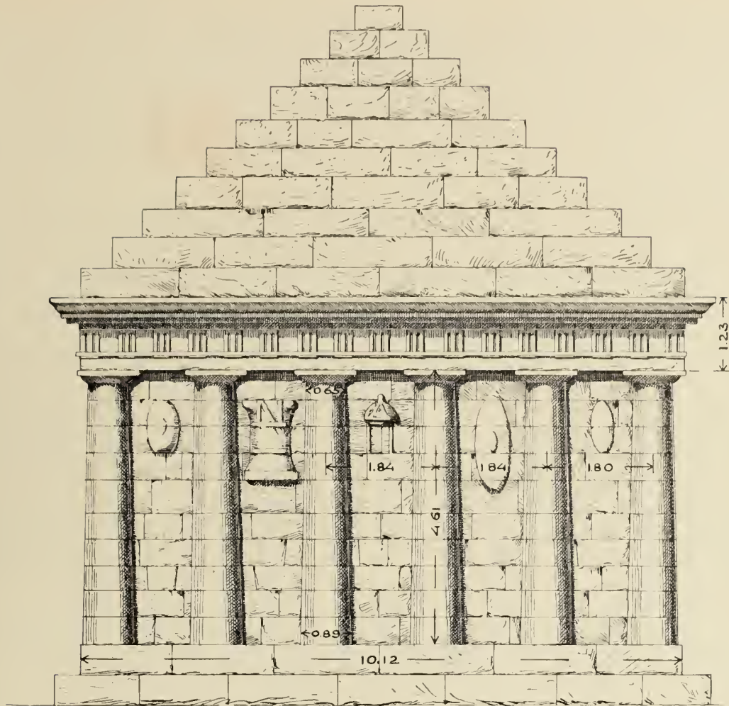
Fig. 994. es-Suwêdâ: Grabmal der Ḥamrath: Aufriß nach den Photographien Fig. 992, 993, und der Abbildung und Beschreibung de Vogüés pl. 1 und pp. 29—31. — Die Maße sind nach de Vogüé p. 30 eingetragen.
